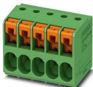
Gleiche Baugröße, unterschiedliche Anschlusstechnik: Mit den formgleichen Leiterplattenklemmen der TDPT-Serie ist es möglich marktspezifische Geräte im einheitlichen Design zu entwickeln. Dank der identischen Baugröße kann man flexibel den Schraub- oder Push-in-Federanschluss wählen und das Leiterplatten- und Geräte-Design beibehalten.
